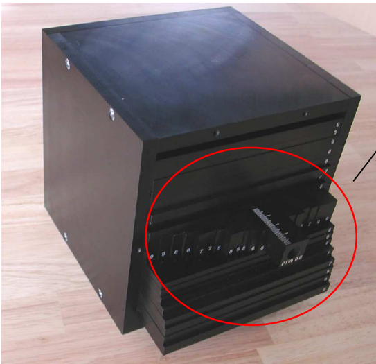
Chamber用Boxファントム（標準装備）は1mmの上下左右の移動が可能
