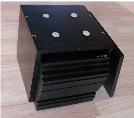
Film用Boxファントム（標準装備）は0.2mm厚として9.8mm厚のファントムが標準装備
