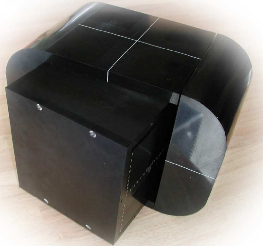
体幹部用ファントム（標準装備）を装着したChamber用ファントム（標準装備）
