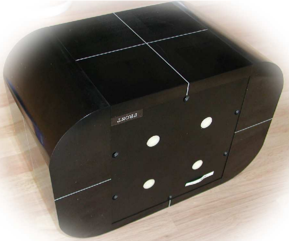
体幹部用ファントム（標準装備）を装着したFilm用ファントム（標準装備）
