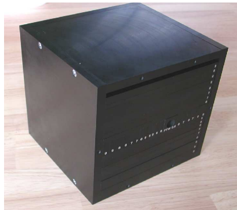
Chamber用BOXファントムを取り付け枠に装着した場合
